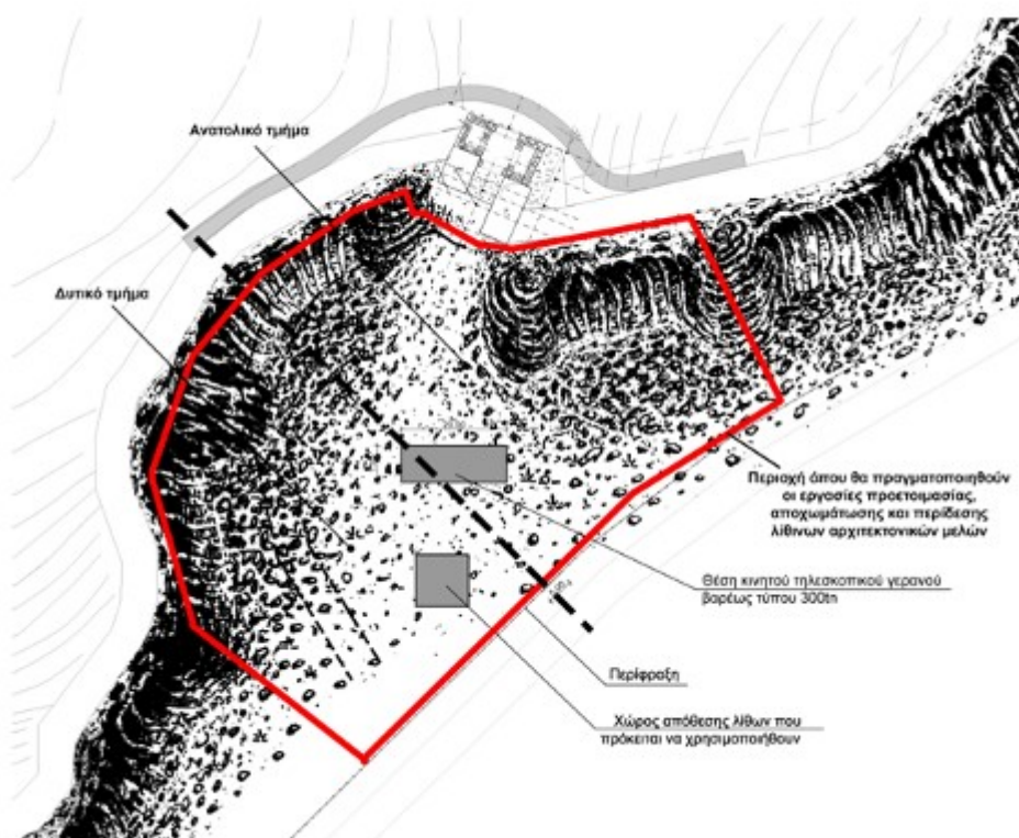
Σχ.1. Σημειώνεται η περιοχή όπου θα πραγματοποιηθούν οι εργασίες προετοιμασίας, αποχωμάτωσης και περίδεσης λίθινων αρχιτεκτονικών μελών (Μελέτη δομικής αποκατάστασης της νότιας πύλης στη μυκηναϊκή ακρόπολη του Γλα Βοιωτίας, 2022)
