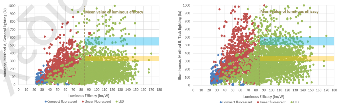
Σχήμα Γ-7: Καταλληλότητα 10.000 εξεταζόμενων φωτιστικών σωμάτων (Βάση δεδομένων, 2018) για την ενεργειακή τους απόδοση στο σχεδιασμό φωτισμού για απαιτήσεις 300lx και 500lx για γενικό φωτισμό (αριστερά) και φωτισμό επιφάνειας εργασίας (δεξιά). Το κίτρινο εμβαδό περιλαμβάνει το σύνολο των κατάλληλων φωτιστικών για επίπεδο φωτισμού 300lx και το μπλε εμβαδό το σύνολο των φωτιστικών για 500lx.
