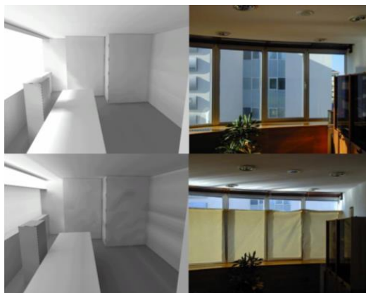
Σχήμα 6-5: Εξισορρόπηση λαμπρότητας με περιορισμό του φυσικού φωτισμού που εισάγεται στο χώρο μέσα από σκιάστρα ή περσίδες.
