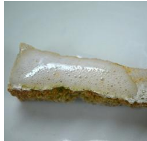
Εικόνα 6.6 Ο έντονος αναβρασμός με HCl υποδεικνύει ασβεστολιθικά πετρώματα, πιο ήπιος αναβρασμός παρατηρείται με λίθους ασβεστιτικής συνδετικής ύλης, όπως ασβεστιτικοί ψαμμίτες. Φωτογραφία: Ιωάννα Ντούτση.
