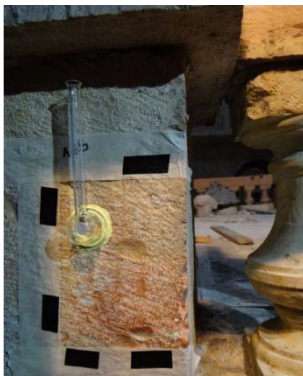
Εικόνα 6.7 Εκτίμηση της υγρομετρικής συμπεριφοράς δομικών λίθων στο πεδίο με σωλήνες Karsten tubes. Φωτογραφία: Ιωάννα Ντούτση.
