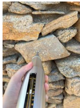
Εικόνα 6.8 Μέτρηση με την σφύρα αναπήδησης Schmidt Hammer σε γνεύσιο στη Δήλο: ο βαθμός φθοράς θα επιδράσει στις μετρούμενες τιμές. Φωτογραφία: Νικηφόρος Μείμαρογλου.
