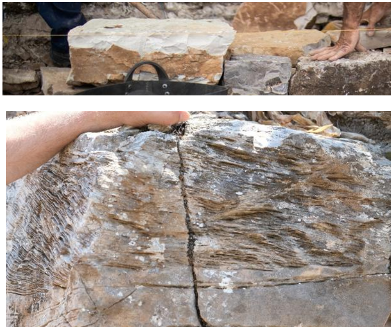
Εικόνα 6.9 Συμπαγείς ασβεστόλιθοι: (πάνω) βιογενής ασβεστόλιθος Ζαγορίου με χαρακτηριστική πορτοκαλί επιφανειακή κρούστα. Τα ασβεστολιθικά πετρώματα εμφανίζουν συχνά τέτοιες επιφάνειες είτε στην κατασκευή είτε σε γεωλογικές θέσεις εμφάνισης.
