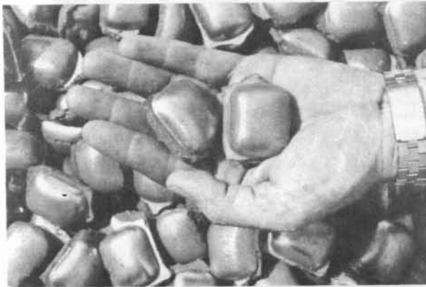
Εικ. 25. Άνηγμένος σίδηρος σε μορφή μπρικεττών.
