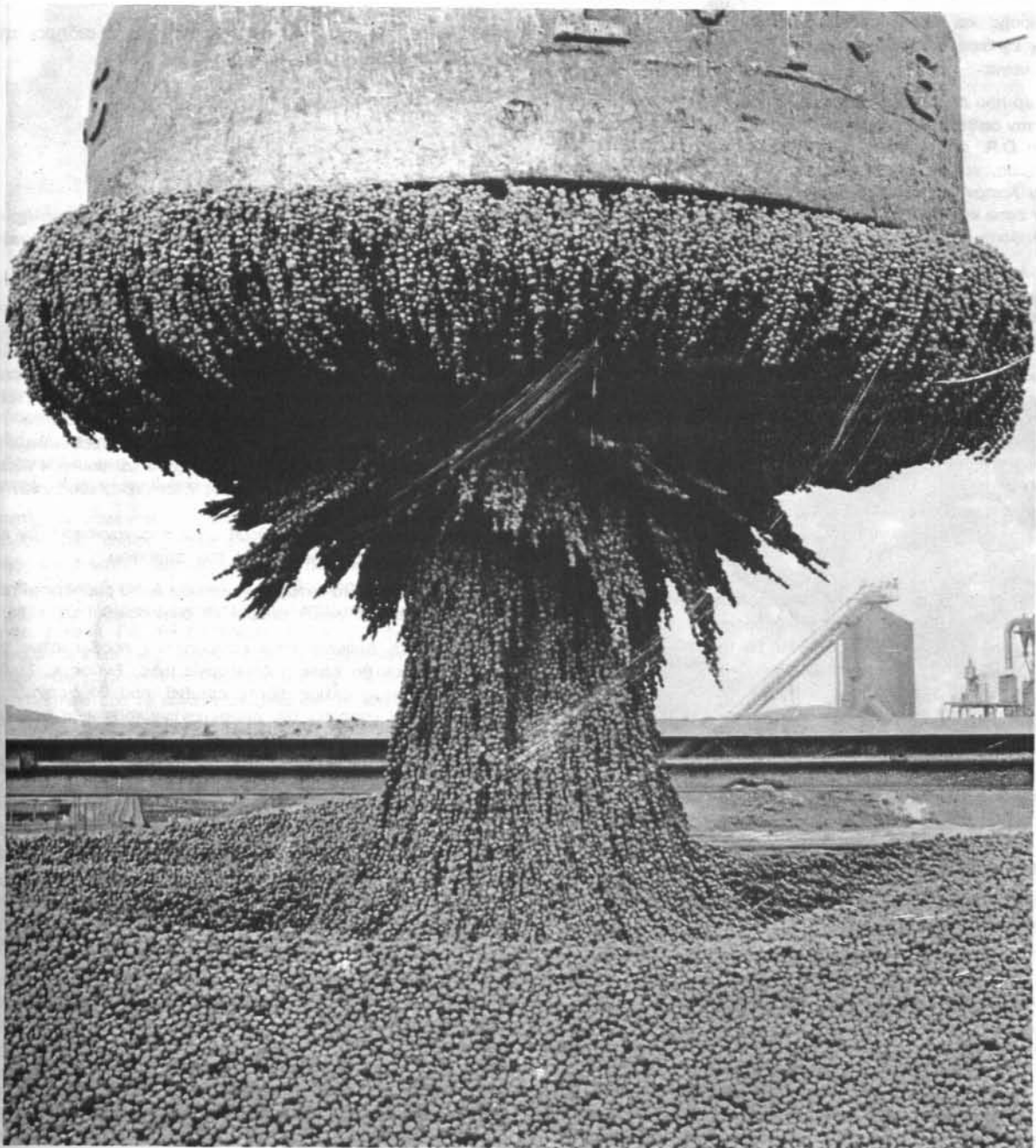
Εικ. 24. Pellets «άνηγγμένου» σιδήρου παρασκευασμένες μέ άπ' εύθείας άναγωγή (D.R.)
