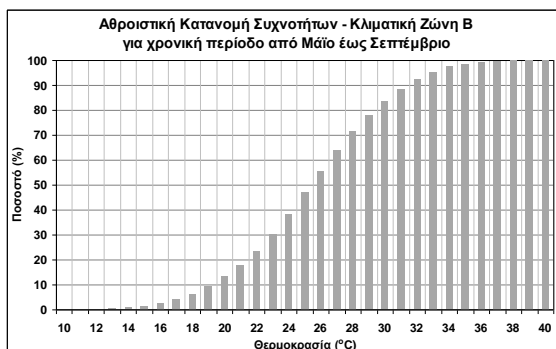
Σχήμα 2.2. Αθροιστική κατανομή συχνοτήτων θερμοκρασίας εξωτερικού αέρα για την Κλιματική Ζώνη Β.
